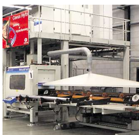
Bearbeitungszentrum für Rohrbiegen und Lasern: Alle Fertigungsprozesse bei Corus laufen hochautomatisiert ab. Foto: Corus
