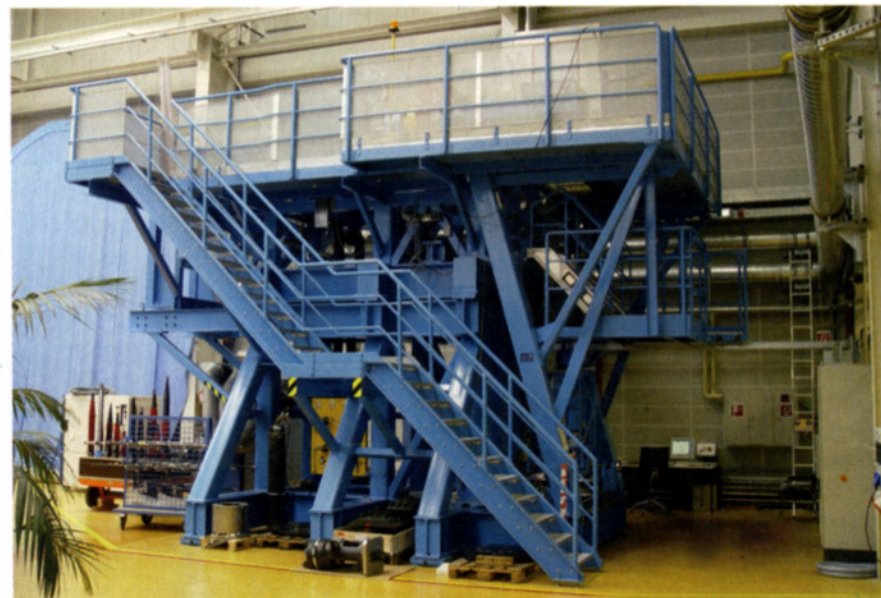
5 iw-Maschinenbau ... verantwortete die Entwicklung und Konstruktion eines neuen Kalibrierprüfstandes für die hoch belasteten Stellantriebe der Landeklappen sowie eines Flugzeug-Flap-Aktuator-Dummies.
